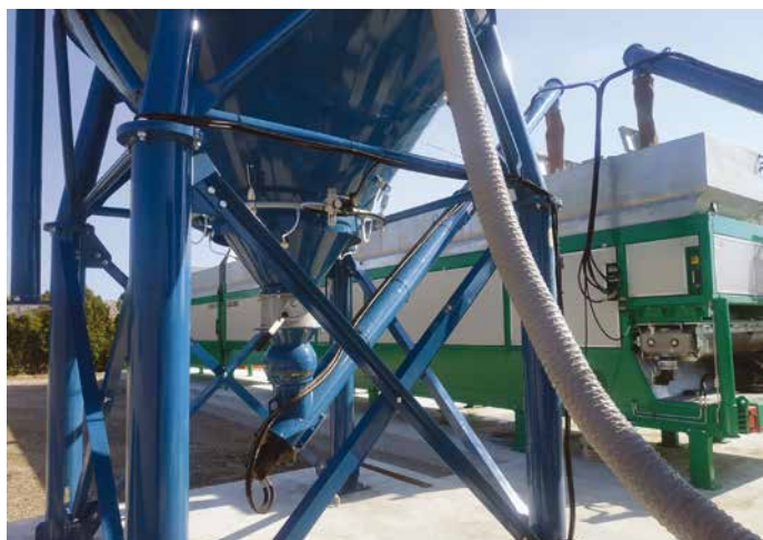
9. Lo stoccaggio dei leganti avviene in silos verticali collocati a fianco dell'A240 e collegati con coclee che lo alimentano in continuo
