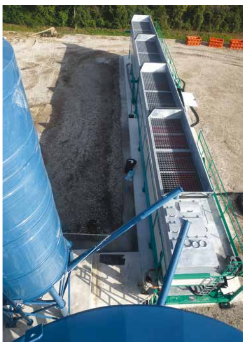
1. I due moduli affiancati dell'A240 Quater permettono di utilizzare quattro diversi inerti senza soluzione di continuità
