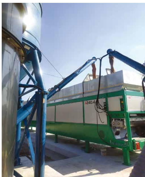
3. In caso di trasporto in altro luogo, i serbatoi verticali si scollegano rapidamente in pochi minuti
